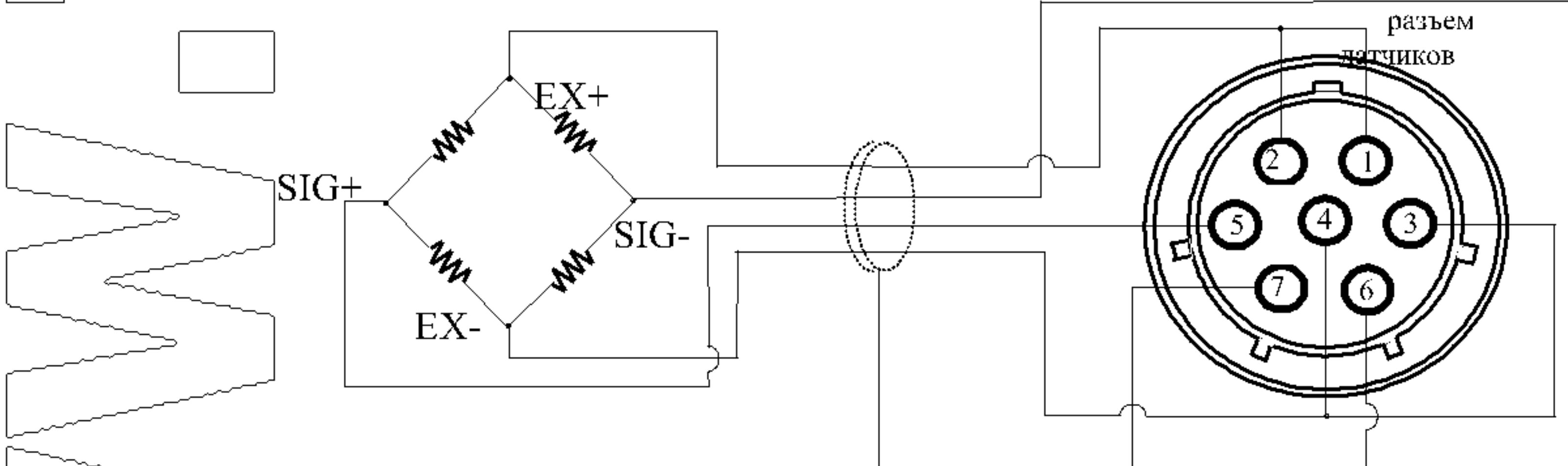
Для проверки тензодатчика отключите питание и проверьте, что напряжение между точками (SIG+, SIG-) такое же, как и при нажатой клавише **ON/OFF** на передней панели.
